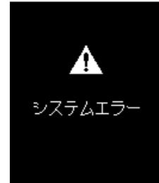
⇒ 正常に起動できませんでした。電池を取り外す、またはマイクロ USB ケーブルを取り外して電源の供給を止め、3 秒程度待つてから再度電源を供給して、電源を入れ直してください。
