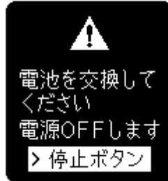
⇒ 電池残量がありません。停止ボタンを押して電源 OFF してください。その後、電池を交換する、もしくはマイクロ USB ケーブルで電源に接続してください。
