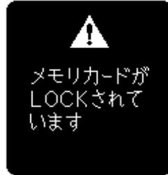
⇒メモリカードがLOCKされています。メモリカードを取り外して、LOCKを解除してください。
