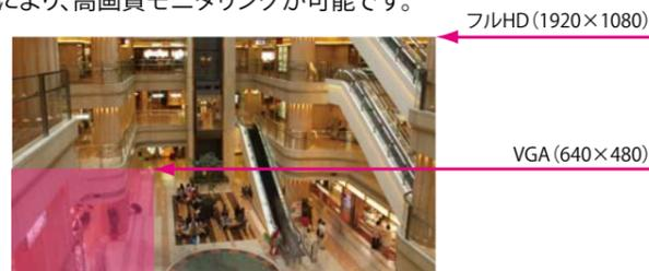
「人物特定」や「車両番号認証」、「紙幣/カード識別」など高精細な映像を必要とする用途への利用が可能。さらにメガピクセル対応 Quad VGA、HD720P、VGA、QVGAの解像度出力にも対応します。
